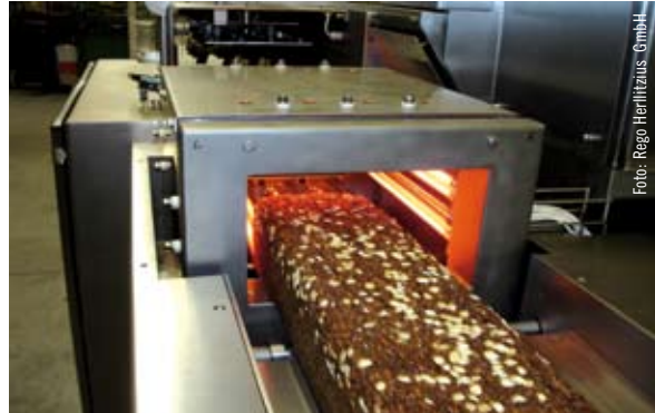
Brot entkeimen vor der Brotschneideanlage
